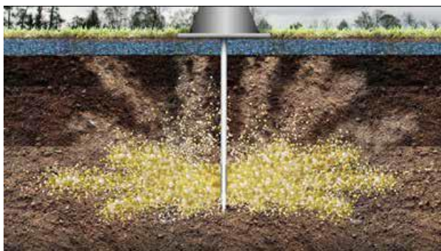
Injektáž půdních aditiv
